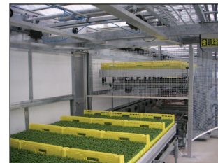
ベンチエレベーター 2階栽培エリアへベンチを搬送します。
