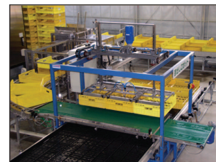
フラットロボット トレーや鉢をベンチにならべる/収穫設備。
