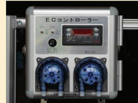
養液コントローラー 単肥 2液混入方式, EC制御
