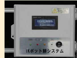
灌水制御盤: タイマー制御, 排水センサーによる給水停止
