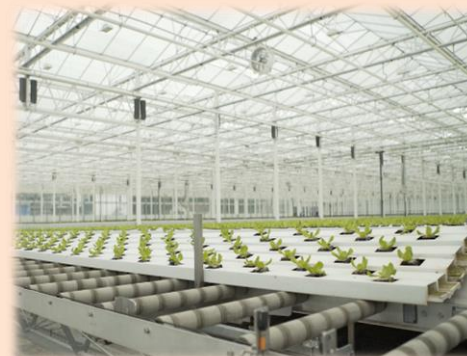
コンベアライン ガターの横移動装置
