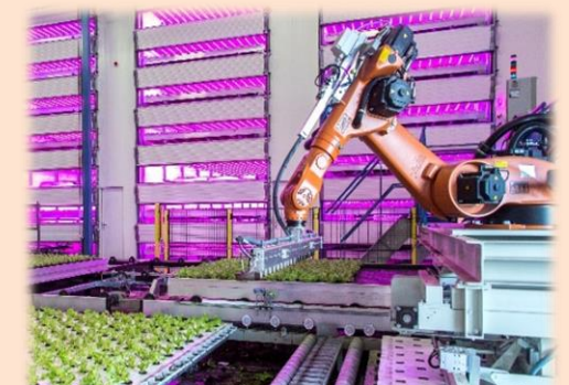
定植ロボット 育苗室から搬出された苗はロボットでガターに定植
